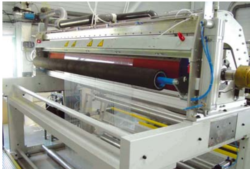
2 Meter Bahnbreite, 300 Meter/Minute Geschwindigkeit – die Oberflächenbehandlung zum Ersatz flüssiger Primer lässt sich in vorhandene Produktionsanlagen integrieren.
