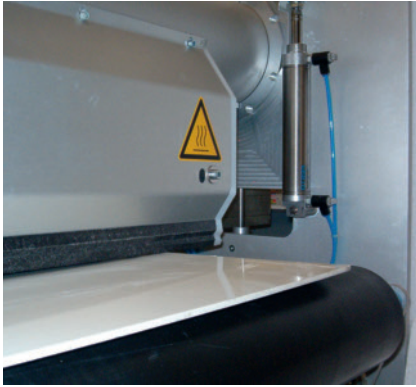
Bild 2. Mit der Oberflächentechnik lassen sich erstmals Materialien beliebiger Dicke behandeln, das Atmosphärendruck-Plasma modifiziert dabei im Sub-Nanometerbereich die Oberfläche
