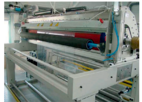
Bild 4. Die Stationen sind für eine Inline-Behandlung ausgelegt und können unter anderem eine Bahnbreite von 2 m haben sowie Produktionsgeschwindigkeiten von 300 m/min erreichen
