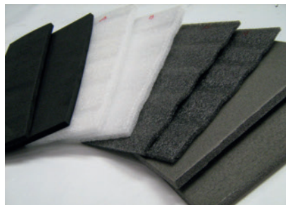
Bild 1. Neben Schaumstoffen mit unterschiedlichen Oberflächen können auch Stegplatten mit dem Plasma-Verfahren behandelt werden, die klassische Corona-Behandlung ist hier nicht anwendbar
